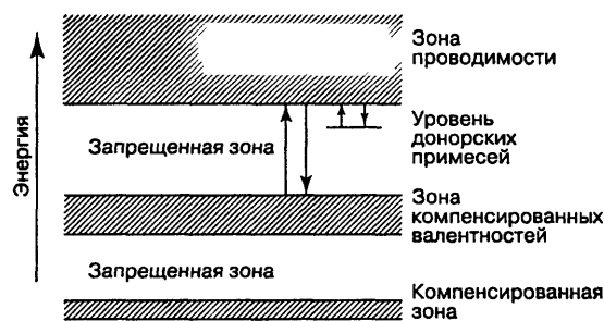
Рис. 6.5 Схема, показывающая энергетические уровни в области кристаллической решетки, которые ответственны за возникновение цвета и люминесценции.
